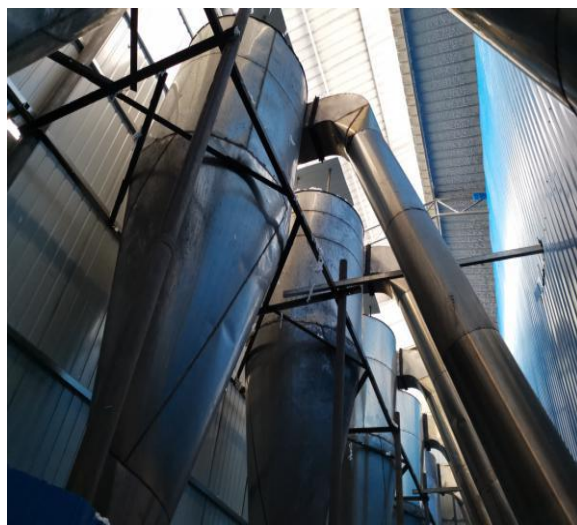
项目喷吹系统与紧密链接的旋风除尘装置
