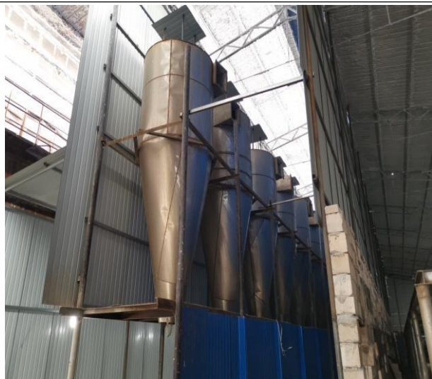
项目喷吹系统与紧密链接的旋风除尘装置
