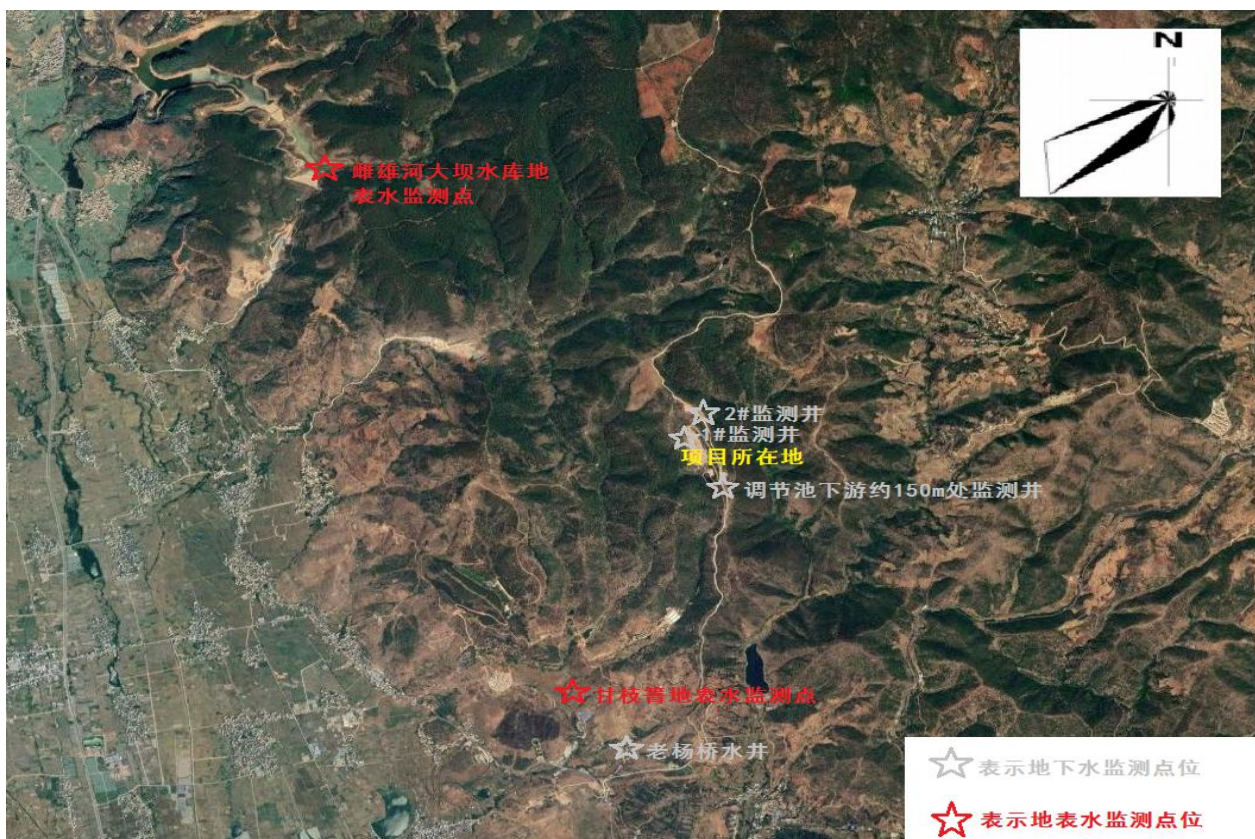
图 7.1-2 项目验收监测点位图（地表水、地下水）
