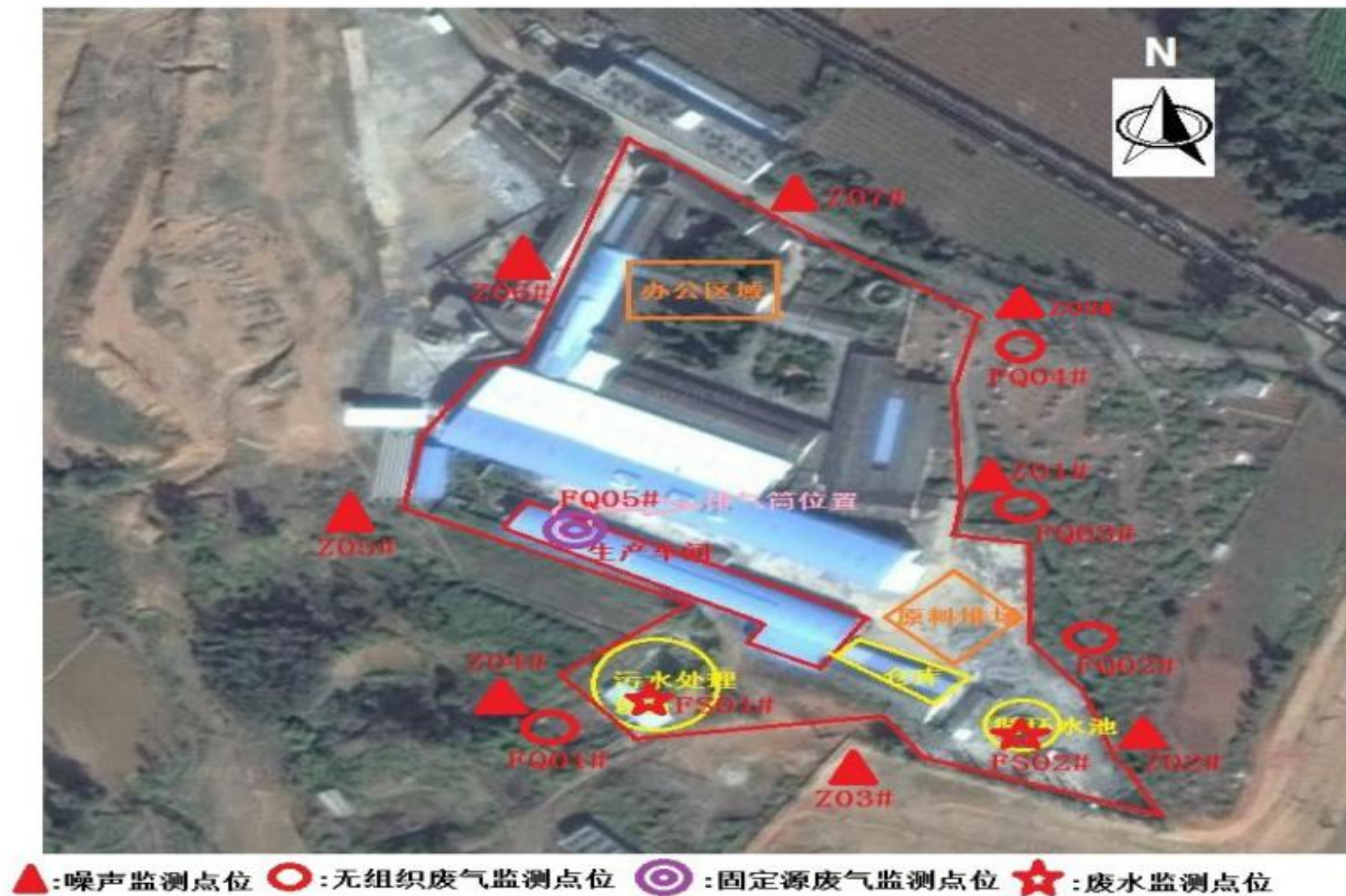
图 7.1-1 项目监测点位图（厂界噪声、废气、废水）
